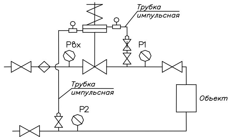
Схема подключения регулятора перепада давления при установке на обратном трубопроводе.
